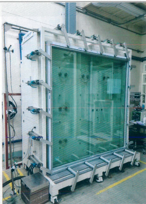
<사진 2> 기밀 시험체 사진(측면)
