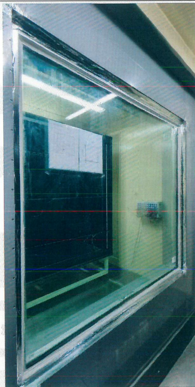
<사진 2> 열관류율 저온측 시험체 사진
