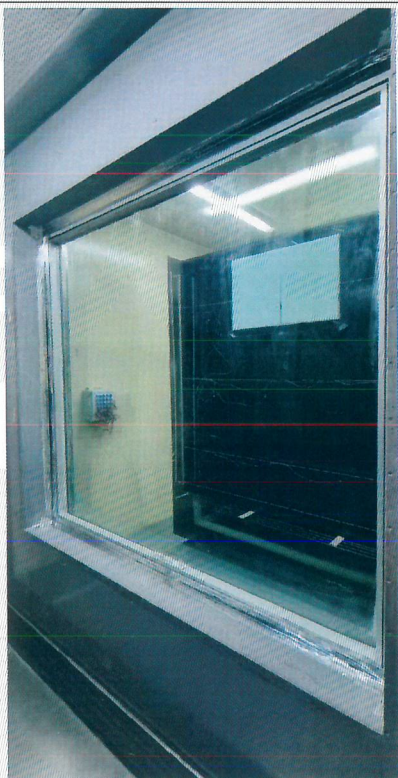
<사진 1> 열관류율 향온측 시험체 사진
