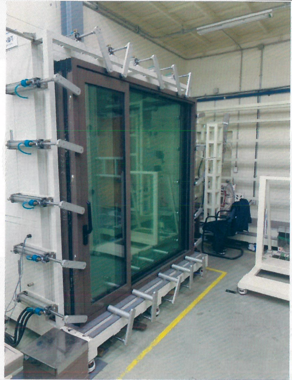
<사진 2> 기밀 시험체 사진
