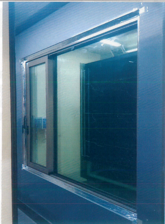
<사진 1> 열관류율 향온측 시험체 사진
