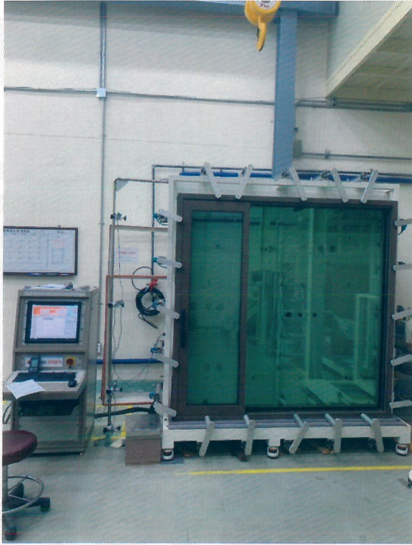
<사진 1> 기밀 시험체 사진
