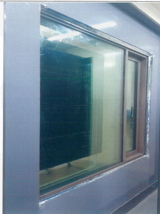
<사진 2> 열관류율 저온측 시험체 사진
