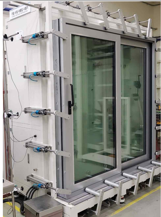
<사진 2> 기밀 시험체 사진(측면)
