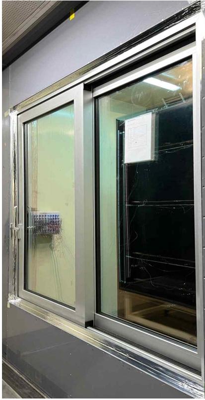
<사진 1> 열관류율 향온측 시험체 사진
