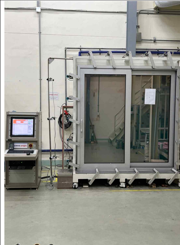
<사진 1> 기밀 시험체 사진(정면)
