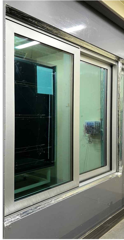
<사진 2> 열관류율 저온측 시험체 사진
