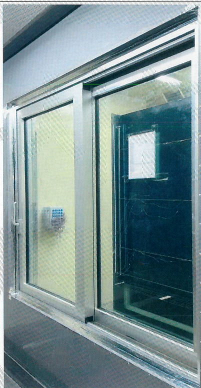
<사진 1> 열관류율 항온측 시험체 사진
