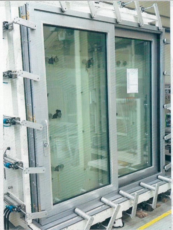
<사진 2> 기밀 시험체 사진(측면)
